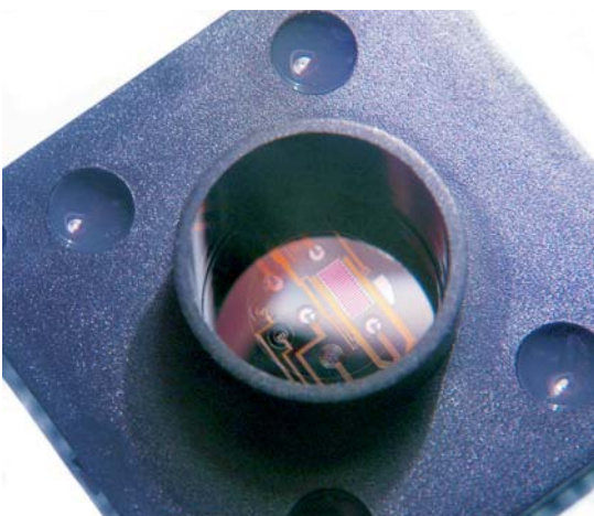
Abb. 3: Silizium-Sensorchip mit Sensoren zur Messung von pH-Änderungen, zur Sauerstoffmessung und zur Adhäsionsbeobachtung
